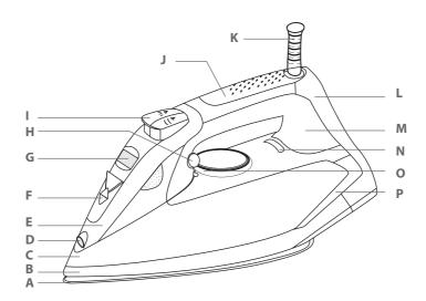
ا دکمه اسپری و بخار بیشتر ک دسته اتو K محافظ سیم L بدنه M بدنه O ولوم تنظیم درجه حرارت E قسمت های تزیینی
