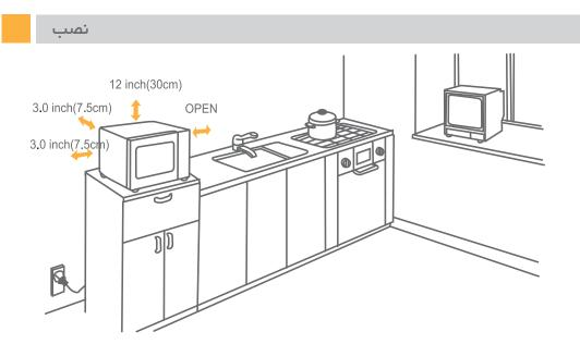
دستگاه را روی سطحی قرار دهید که فضای کافی برای شبکههای ورودی/خروجی هوای مایکروویو وجود داشته باشد.
