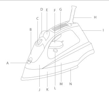
H: محافظ سیم برق I: پوشش پشتی I: بدنه دستگاه K: لبه ی بدنه L: دکمه خود تمیزکاری M: مخزن آب N: کفی اتو
